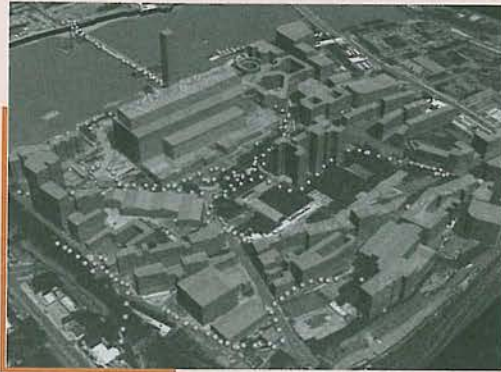
شکل ۲: محل اندازه گیری های درجه حرارت دما، رطوبت نسبی و سرعت باد که توسط GPS در اطراف موزه مدرن تیت ثبت شده است.
